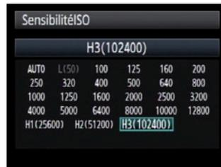
Avec la fonction C.Fn I-3 "Régler extension ISO" lorsque la limite supérieure est réglée sur H3, il est possible de sélectionner des réglages ISO très élevés entre 25.600 et 102.400 ISO. Mais quel est le potentiel concret du réglage 102.400 ISO ? Les résultats d'un essai de prises de vues en lumière ambiante ultra-faible vous étonneront.
