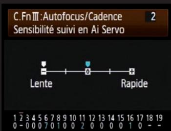
Lorsque la sensibilité de suivi AF est réglée sur la position "lente" (option -2), la durée pendant laquelle des objets apparaissant dans le collimateur sont considérés comme des obstructions est plus longue que lorsque le réglage est sur l'option "lente" intermédiaire (-1). Ainsi, lorsque la durée pendant laquelle un sujet est masqué par une obstruction est courte (pour référence, une durée longue est de l'ordre de "0,x" sec.), ce réglage peut s'avérer très efficace.
