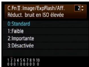
Régler C.Fn II-2 "Réduct. bruit en ISO élevée" sur l'option: 0 Standard, 1: faible, 2: Importante, 3: Désactivée, et vérifier les variations de qualité d'image.
