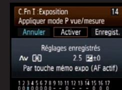
Avec C.Fn I-14 option "Enregist." il est possible d'enregistrer le mode d'exposition, le mode mesure, la vitesse, l'ouverture et une correction d'exposition afin de les rappeler instantanément en appuyant sur la touche de mémorisation d'expo.
