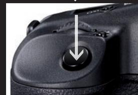
Pression à fond sur le déclencheur après que l'AF ait fonctionné pendant environ 0,5 sec.
