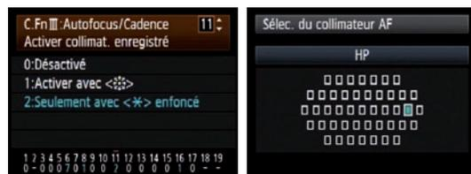
En mode de sélection manuelle des collimateurs, sélectionner le collimateur souhaité en appuyant sur la touche de sélection de collimateur AF. Une fois le collimateur choisi, appuyer sur la touche ISO. Le collimateur AF est alors enregistré et cette action confirmée par un bip.
